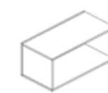
Nicho móvel vazado *c/ fechamento posterior *capacidade de carga 15kg
